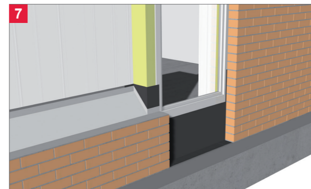
7 Die Abdichtung im Bereich der Schwelle abschließend mittels einer EPDM-Bahn und ELMCO – Sperrfolienkleber herstellen.
