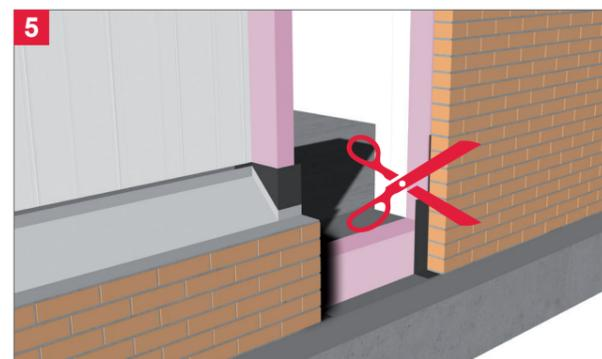
Vor der Fenstermontage die 1,3 mm dicke EPDM-Bahn entsprechend dem Bauelementerahmen auf die notwendige Höhe zuschneiden.
