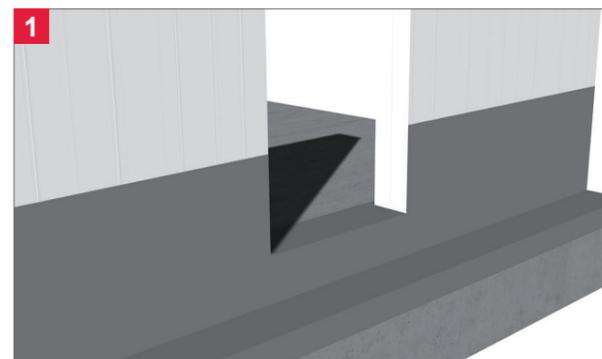
Hintermauerwerk mit Sockelabdichtung, Bohrungen für die Dübel anzeichnen und mit Bohrer  $\varnothing$  8 mm bohren.
