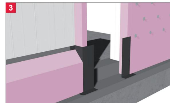
Fugenblockstreifen in Fortsetzung der ELMCO-FPAE II-XPS und Gefällekeile zur Entwässerung des Schalenzwischenraumes anbringen.
