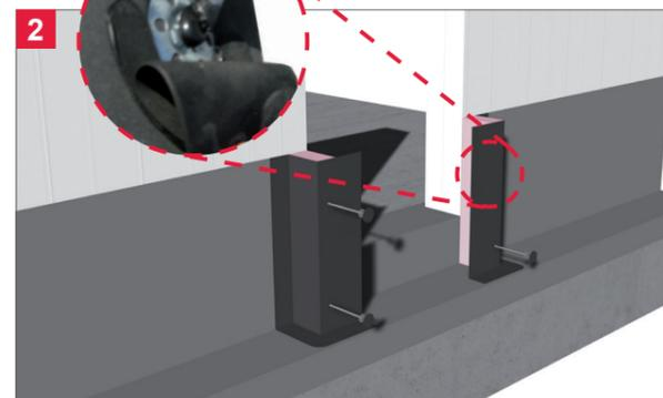
Die ELMCO-FPAE II-XPS ansetzen, mit ELMCO-Sperrfolienkleber andichten, mit den beiliegenden Dübeln im Hintermauerwerk befestigen, Öffnungen mit Dichtpads versiegeln.
