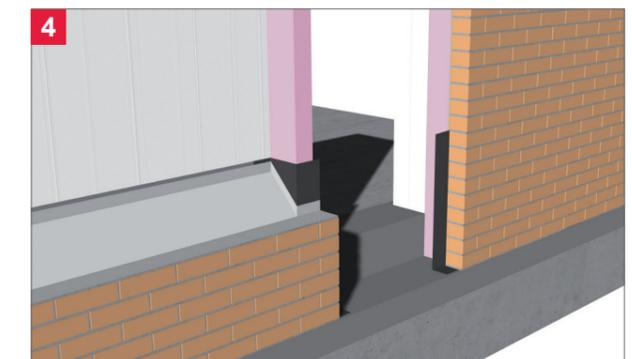
Das Verblendmauerwerk kann errichtet werden, bevor die Fenster eingebaut sind.
