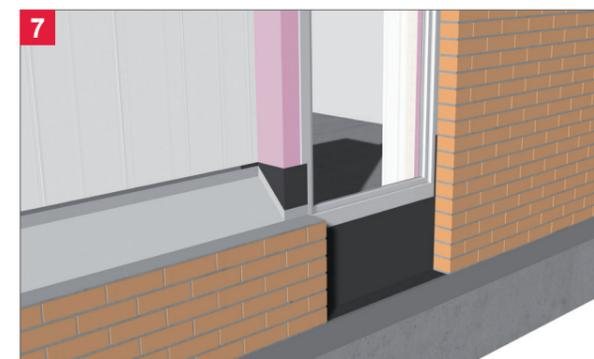
Die Abdichtung im Bereich der Schwelle abschließend mittels einer EPDM-Bahn und ELMCO-Sperrfolienkleber herstellen.
