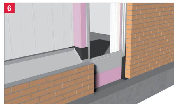
Beim Einbau der Fenster wird die überlappende Abdichtung des ELMCO-FPAE II-XPS mittels Selbstklebung auf dem Fensterahmen appliziert. Das Kompriband liegt zwischen Abdichtung und Verblendschale.
