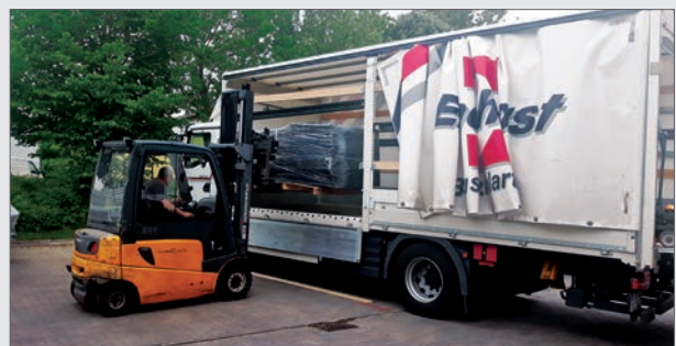
Gefaltete ELMCO – Form Typ FSS-II Elemente müssen mit Hubfahrzeug seitlich entladen werden.
