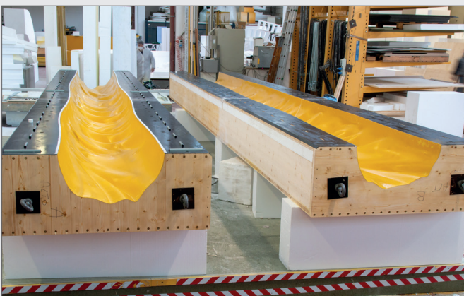
Stützenschalungen für spezielle Säulen
