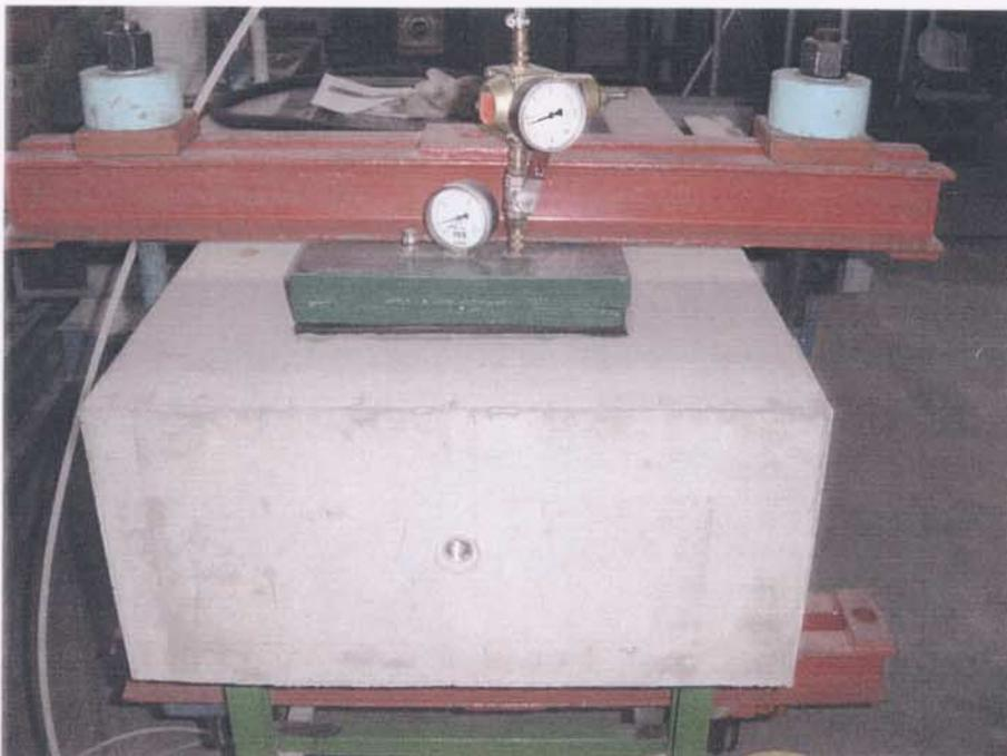
Bild 2: Probekörper während der Prüfung der Druckwasserdichtigkeit
