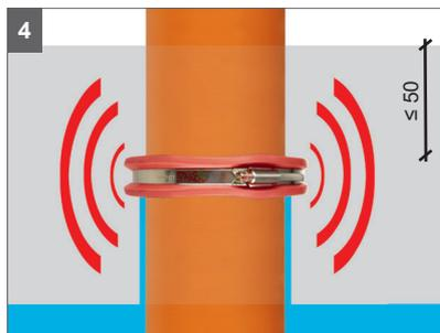
Das umschließende Betonbauteil ist aus Beton mit hohem Wassereindringwiderstand herzustellen. Im Bereich der Rohrdurchführung muss der Beton besonders sorgfältig verdichtet werden, um Hohl- und Fehlstellen zu vermeiden.
