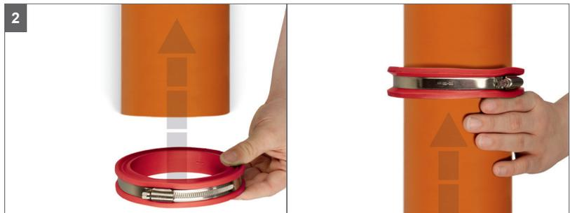
Aufschieben des Mauerkragens bis in die Mitte des später umschließenden Betonbauteils (z. B. Bodenplatte). Als Mindestüberdeckung sind auf beiden Seiten 50 mm bis zur Betonaußenkante einzuhalten.
