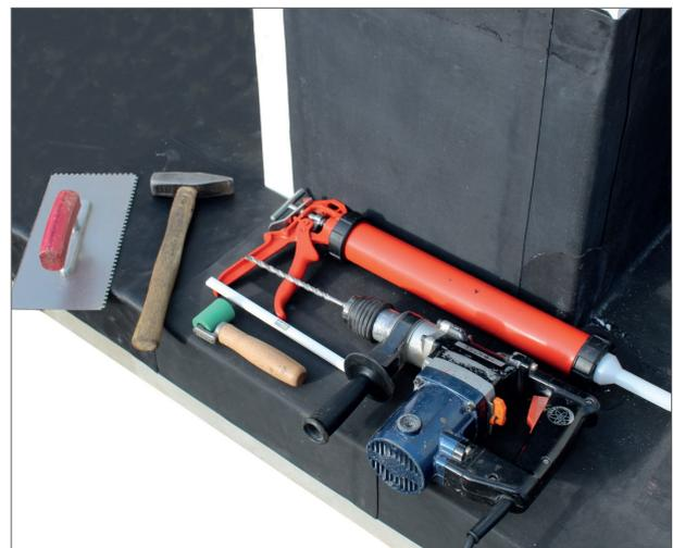
Zum Einbau benötigt werden: Andrückrolle, Bleistift, Bohrmaschine, ELMCO – Sperrfolienkleber, Hammer, Perimeterklebschaum (oder PMBC) und Zahnpachtel.
