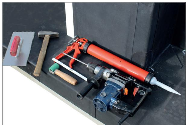
Zum Einbau benötigt werden: Andrückrolle, Bleistift, Bohrmaschine, ELMCO – Sperrfolienkleber, Hammer, Perimeterklebschaum (oder PMBC) und Zahnpachtel.
