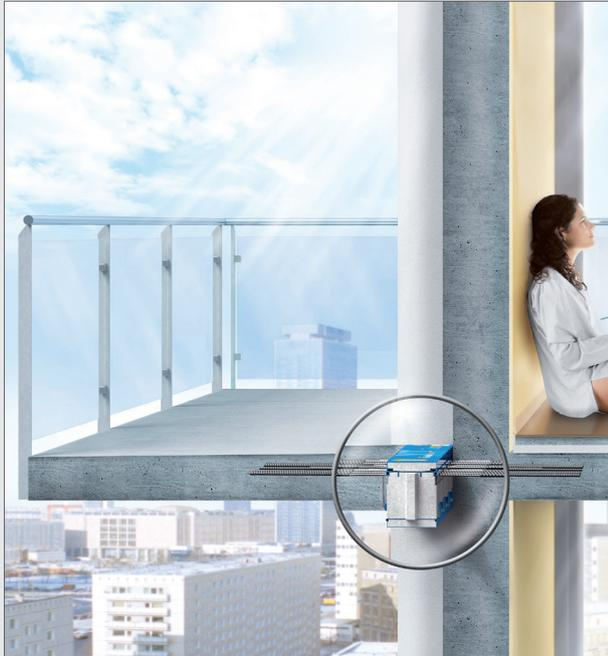
Wärmebrücken an auskragenden Bauteilen sind häufig die Ursache für erhöhten Heizwärmeverlust, feuchte Wände und Schimmelpilzbildung. Die tragenden Wärmedämmelemente von Schöck minimieren Wärmebrücken auf höchstem Niveau, vermeiden damit Bauschäden und bieten dem Planer optimale Gestaltungsfreiheit.
