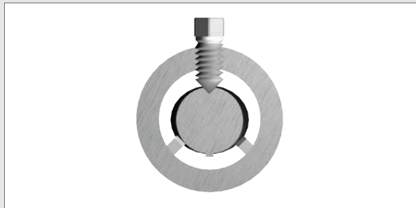
Die Zeichnung zeigt, wie die Schersbolzen und die Zahnleisten in den Betonstahl und die Kupplungshülse eindringen
