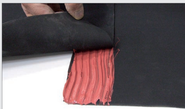
ELMCO – Sperrfolie-EPDM, geprüfte Verklebung der Stöße
