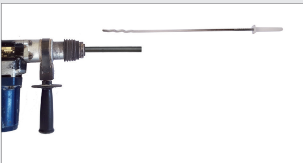
Bohrhammer mit Adapter und Luftschichtanker
